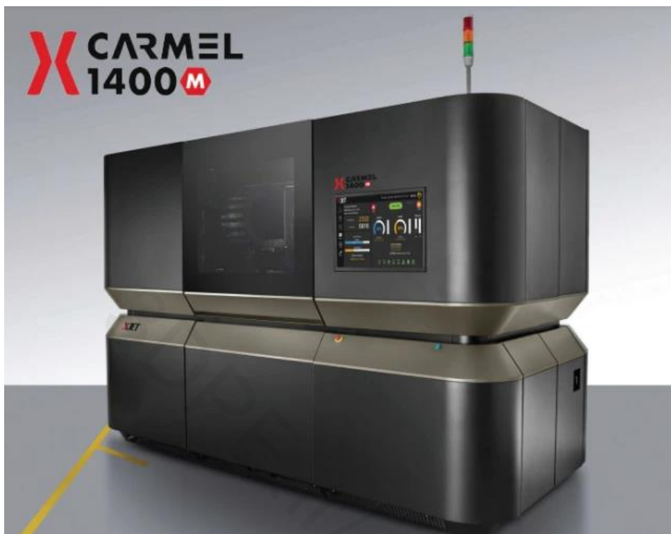
ماشین XJet's Carmel 1400 سازنده قطعات سرامیکی یا فلزی با دقت، قابلیت تکرار و سرعت بالا است.
