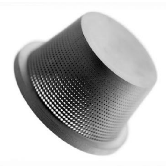
دو نمونه قطعه حاصل از فناوری بایندرجت؛ برای ایجاد قطعه رنگی از نازلهای جوهرافشان چین ریزش ماده چسبیده استفاده میشود.
