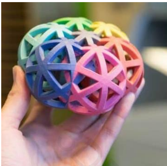
دو نمونه قطعه حاصل از فناوری بایندرجت؛ برای ایجاد قطعه رنگی از نازلهای جوهرافشان چین ریزش ماده چسبیده استفاده میشود.
