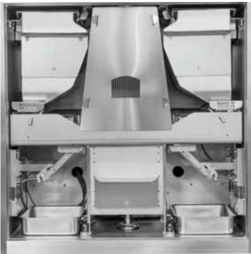
Arcam Q10plus build chamber.
